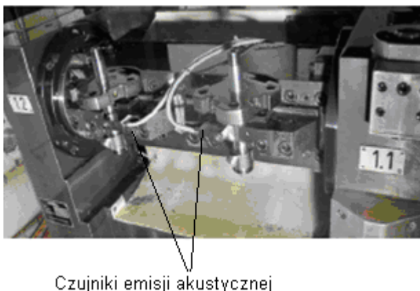
Rys.9. Czujnik emisji akustycznej w układzie nadzorowania [7] Fig.9. Acoustic emission sensor in the monitoring system [7]
